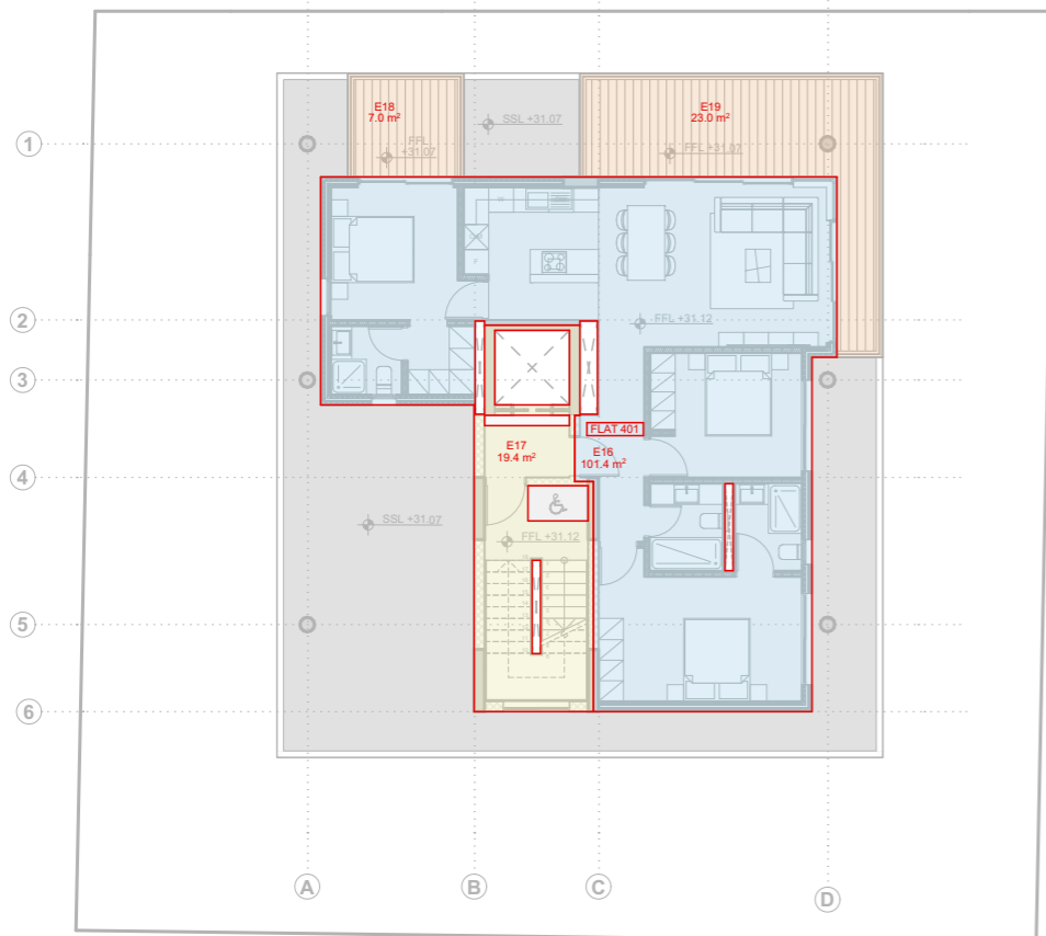
ΕΜΒΑΔΟΜΕΤΡΗΣΗ - 4ος ΟΡΟΦΟΣ ΚΛΙΜΑΚΑ 1:200 E16 + E17 = 101.4 + 19.4 = 120.8 m 2
