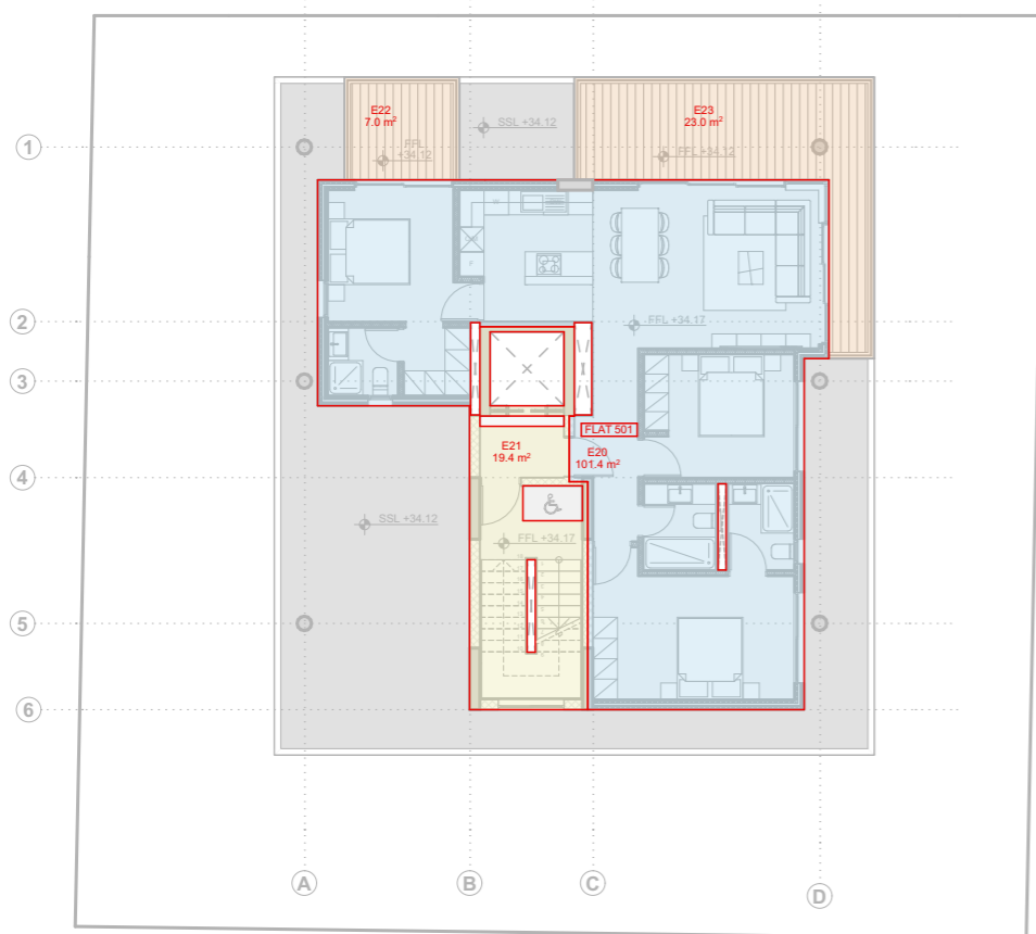
ΕΜΒΑΔΟΜΕΤΡΗΣΗ - 5ος ΟΡΟΦΟΣ ΚΛΙΜΑΚΑ 1:200 E20 + E21 = 101.4 + 19.4 = 120.8 m 2
